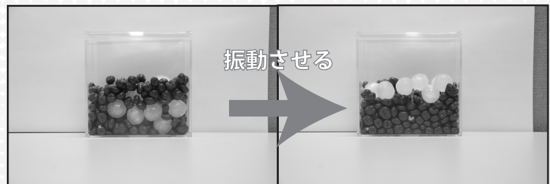
↑ブラジルナッツ効果の実験の様子。左の写真のように小さい粉体(麦チョコ)の中に大きい物体(飴)を入れておき、振動させると右の写真のように飴が浮上する。(写真提供: 東京大学佐野研究室)
