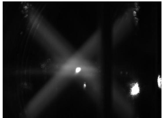
図 3.6 磁場を入れているときの、ガラスセル内の様子。レーザーの交点にひときわ明るい場所ができる。
