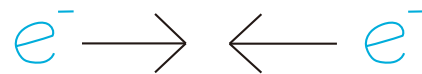
Figure 20. 仮想的な引力で結ばれる電子対をクーパー対と呼びます。
