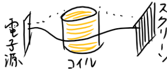
Figure 1. Aharonov-Bohm 効果は電子の二重スリット実験で観測されます。コイルの外は A \neq 0, F = 0 で、コイルの電流により干渉縞が変わります。
